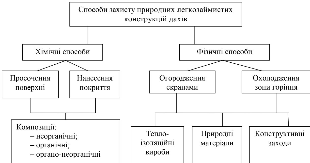
Рис. 1. Способи вогнезахисту природних легкозаймистих конструкцій дахів (соломи та очерету)
