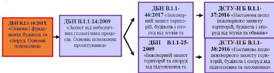
Рис. 2. Структура комплексу нормативних документів та стандартів щодо проектування основ і фундаментів споруд в зоні впливу небезпечних геологічних процесів
