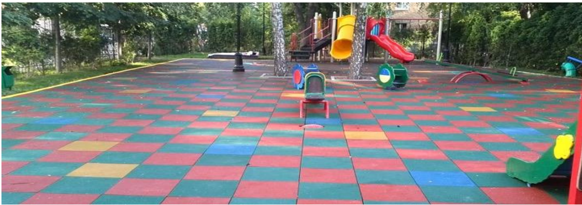
Рис. 3. Застосування гумової крихти для покриття дитячих майданчиків
