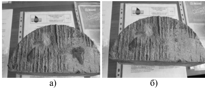
Рис. 5. Характер змочування бетонної поверхні, обробленої реагентом Ravix CCC100 ® (а) і необробленої (б)
