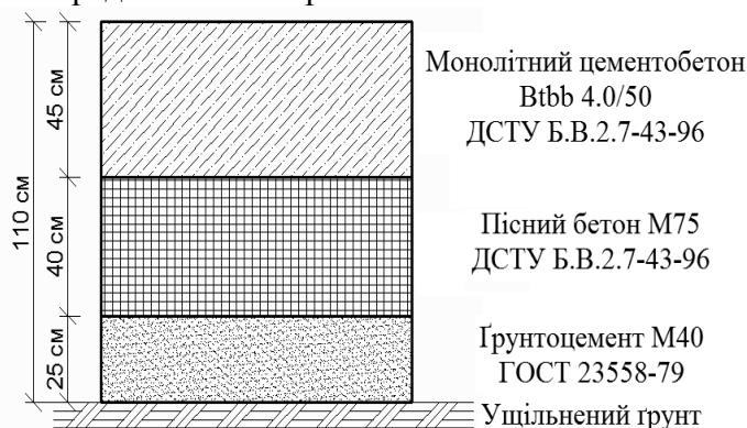
Рис. 1. Конструкція аеродромного одягу ЗПС ДП “Міжнародний аеропорт “Львів” імені Данила Галицького”
