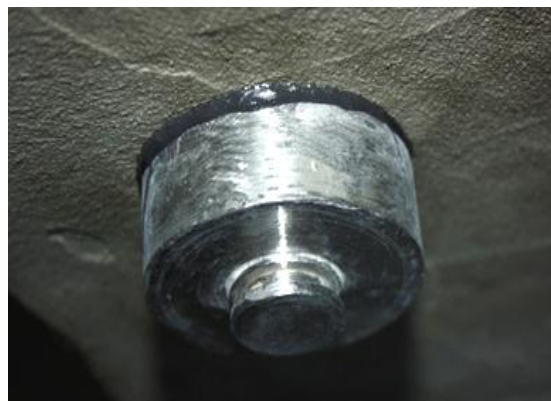
Рис. 3. Вигляд приклеєного циліндра до поверхні гідроізоляції зі щільним швом клею
