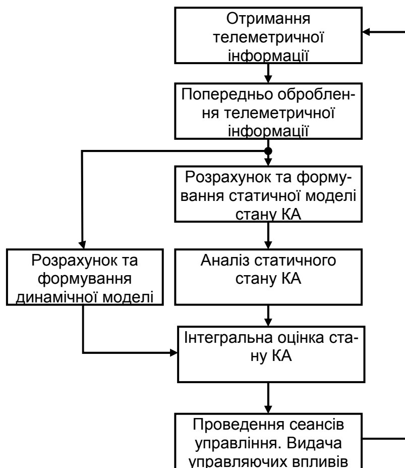
Рис. 1. Функціональна схема способу автоматизованої оцінки телеметричної інформації про стан бортових систем космічних апаратів
