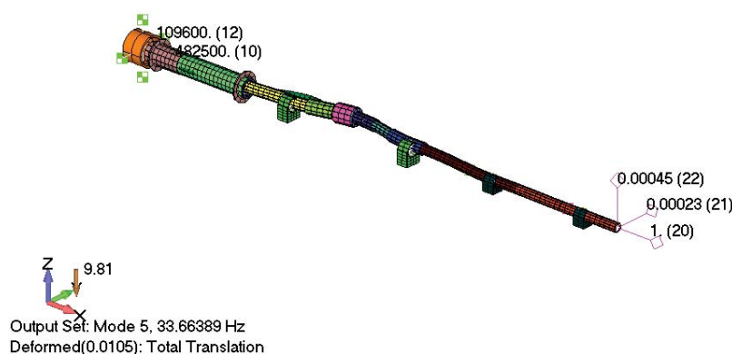
Рис. 3. Форма изгибных колебаний в глобальной вертикальной плоскости 33,7 Гц (одна из резонансных частот)
