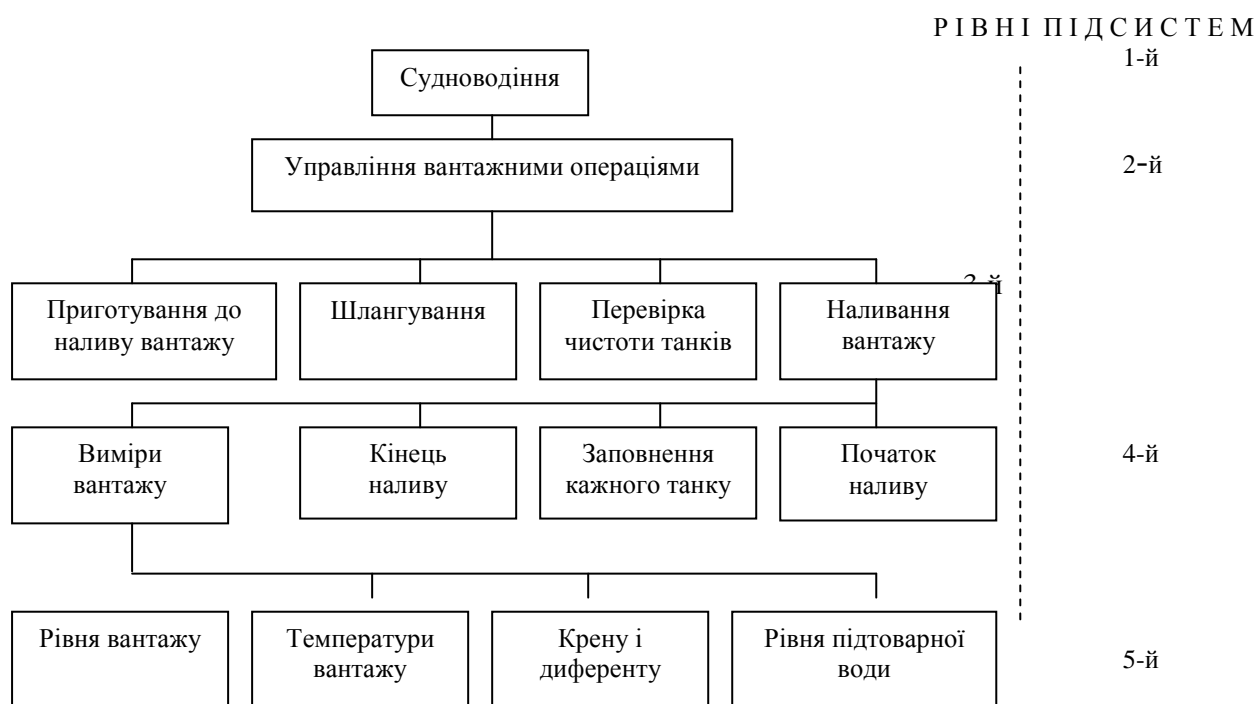
Рис. 2. Класифікація суднової ергатичної підсистеми другого рівня «управління вантажними операціями» на наливному судні
