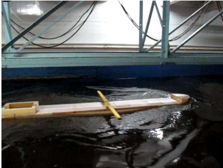
Рис.2. Движение модели в условиях регулярного волнения \lambda/L = 0,75 ; h/\lambda = 1/40 ; Fr = 0,125
