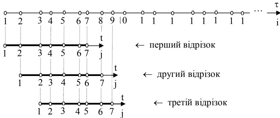
Рис. 1. Схеми розбивки області визначення функції на відрізки апроксимації методом ковзних відрізків, де \tau – глобальний час, t – локальний час
