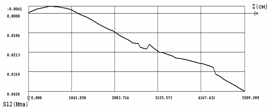
Рис. 3. Эпюра касательных напряжений \sigma_{12} по сечению I-I
