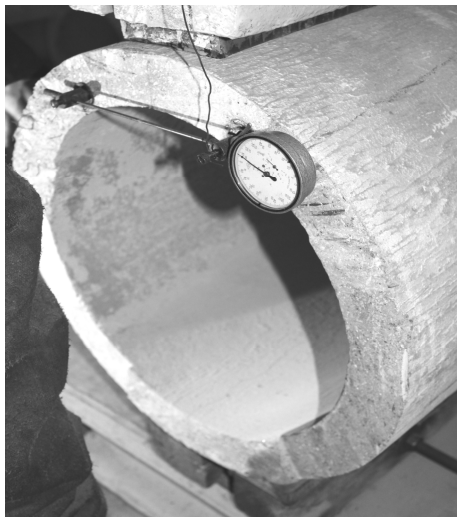
Рис. 2. Измерение деформаций растяжения сталефибробетона
