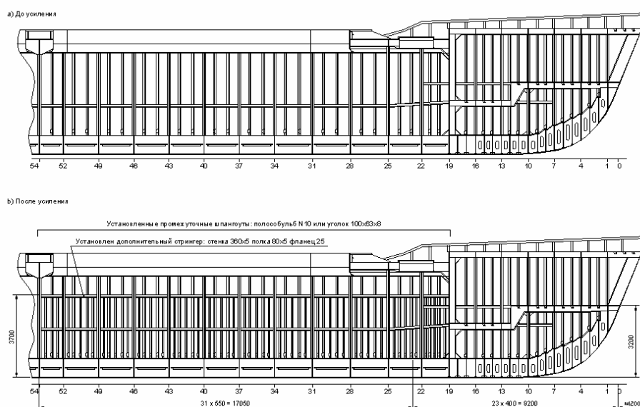
Рис. 3. Ледовые усиления на судне пр. 21-89
