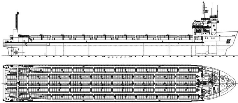
Рис. 3. Общее расположение морского парома «Авангард» проекта CNF06
