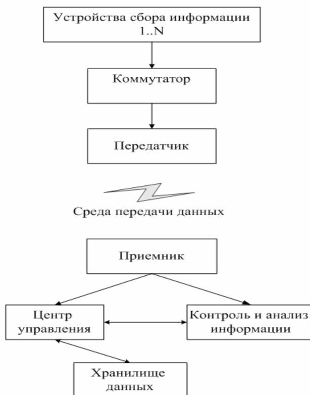
Рис. 1. Типовая структура СМДП
