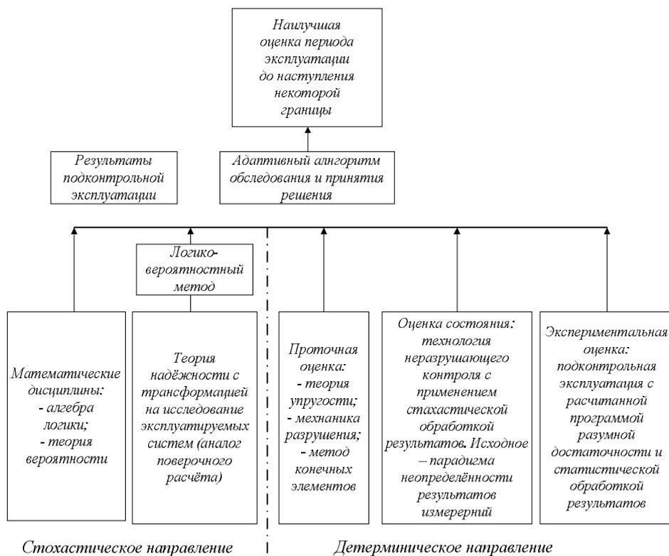
Рис. 3. Схема алгоритма прогнозирования состояния ТС
