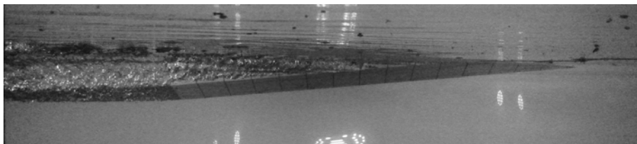
Рис. 4. Характерный вид подводной части модели «с кавитаторами»: а) скорость буксировки 1,33 м/с; б) скорость буксировки 2,37 м/с; в) скорость буксировки 4,53 м/с; г) скорость буксировки 6,09 м/с
