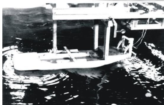
Рис. 2. Модель с ВД: а – во время монтажа; б – на волнении при проведении экспериментальных исследований
