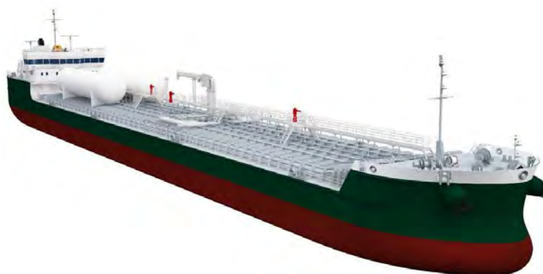
Рис. 6. Расположение криогенных емкостей для хранения газомоторного топлива на танкере «Волго-Дон макс» класса
