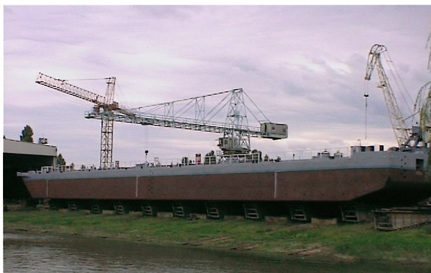
Рис. 5. Баржа типа «Европа-2Б» проекта 1635ОМДЛ на стапеле КССРЗ
