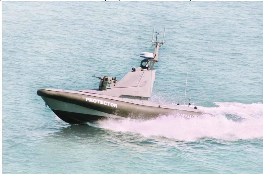
Рис. 2. БЕК з корпусом типу «V-Hull» Protector (Rafael Advanced Defense Systems Ltd., Ізраїль)
