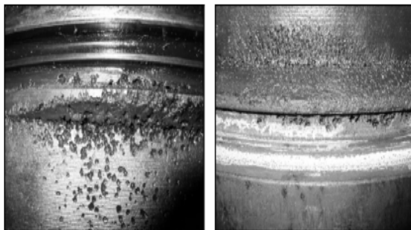
Рис. 5. Кавитационное разрушение цилиндровых втулок судового двигателя
