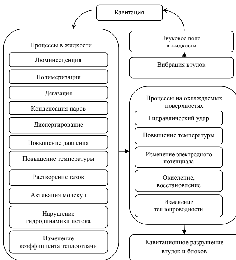
Рис. 1. Схема процесса кавитационного разрушения охлаждаемых полостей СДВС
