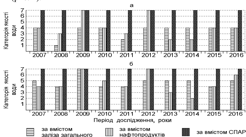
Рис. 2. Категорії якості води р. Киргиж-Китай за показниками блоку речовин токсичної дії: а – за середньорічними значеннями; б – за максимальними значеннями
