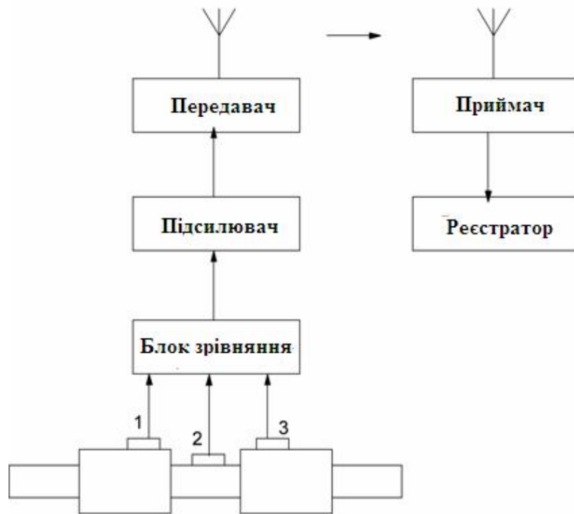
Рис. 4. Структурна схема тензометричного витратоміра
