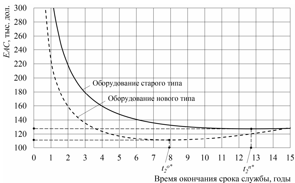
Рис. 1. Графики изменения ЕАС для оборудования старого и нового типа в зависимости от времени окончания срока службы
