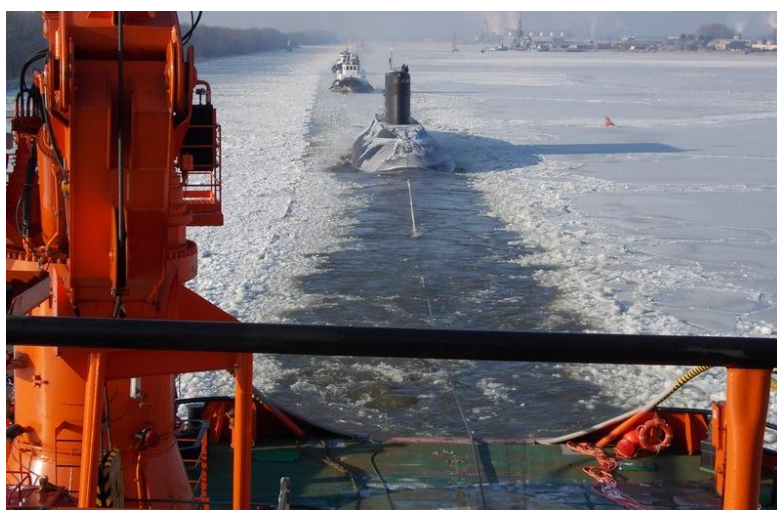
Рис. 2. Буксировка подводной лодки электроходом проекта MPSV07 «Спасатель Карев» из Санкт-Петербурга в Калининград
