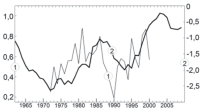
Рис. 9. Внутригодовой диапазон изменения УГВ на изученной территории Одессы (кривая 1) (эквивалентные метры) (левая ось) и отклонение скорости суточного вращения Земли от стандартной (кривая 2) ( n \cdot 10^{-12} рад/с) (правая ось).
