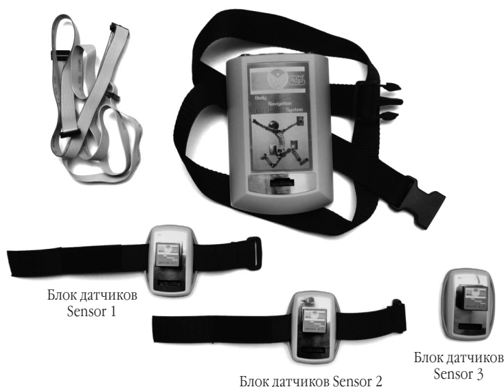
Рис. 2. Инерциальная система оценки кинематических характеристик опорно-двигательного аппарата человека
