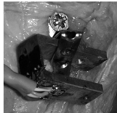
Рис. 2. Загальний вигляд оригінального тензометричного датчика зусилля та спосіб його закріплення на передній поверхні великогомілкової кістки
