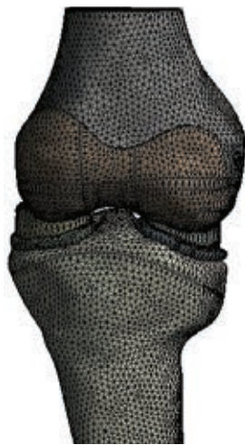
Рис. 2. Скінчено-елементна розрахункова модель колінного суглоба пацієнта з варусною деформацією гомілки при хворобі Блаунта
