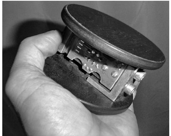
Рис. 1. Мануальний м'язовий тестер на базі датчика механічного зусилля
