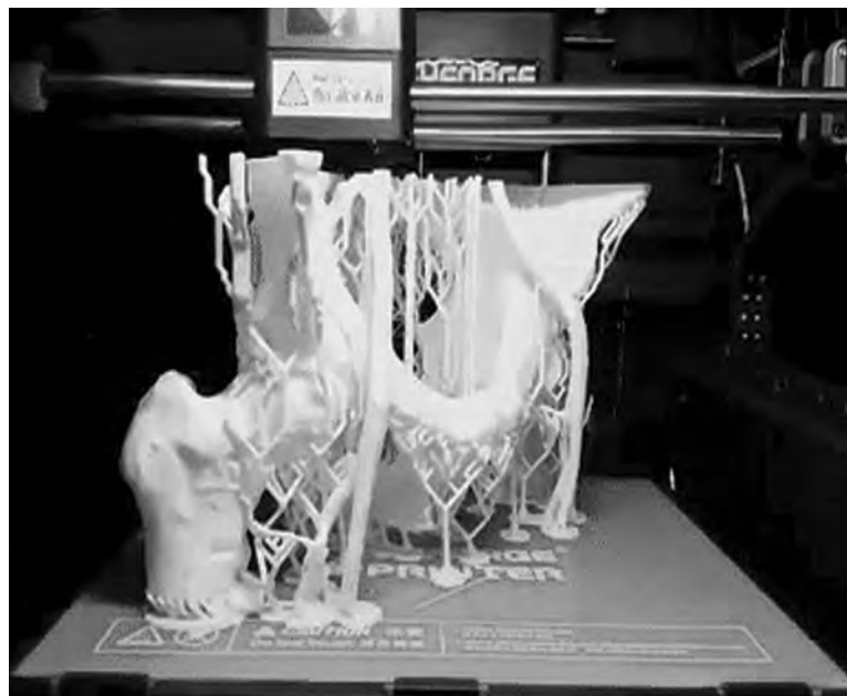
Рис. 5. Процес 3D-друку кісток таза
