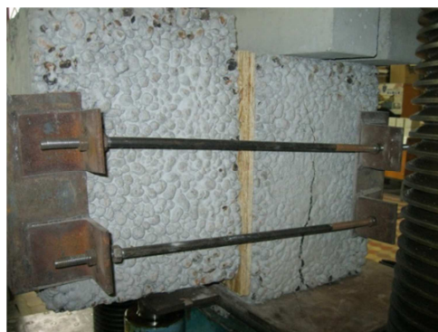
Рис.10. Образование трещин в бетонных призмах
