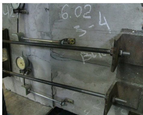
Рис. 8. Образование трещин по контакту растворного шва
