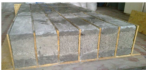
Рис. 1. Опытные образцы трехслойных балок
