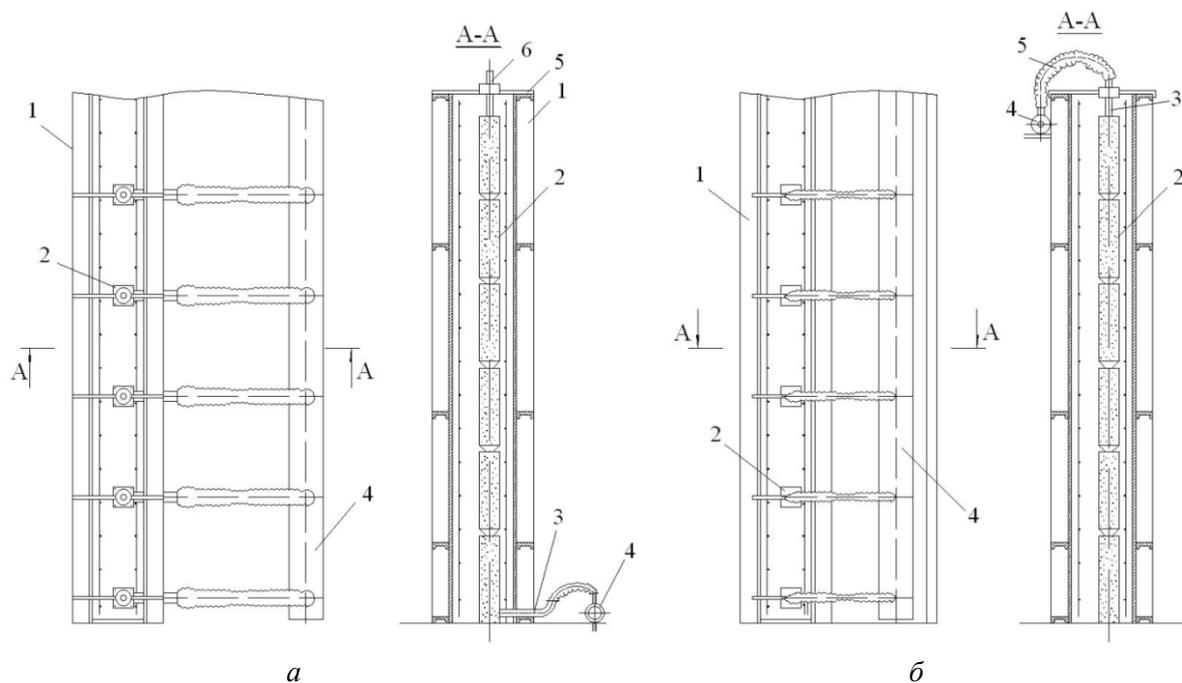
*Рис. 1. Вакуумная обработка монолитного бетона при помощи вакуумтрубок разового использования: а – при подключении снизу; б – при подключении сверху; 1 – опалубка; 2 – вакуумтрубка разового использования; 3 – приемник; 4 – коллектор; 5 – направляющая; 6 – соединительная трубка*
