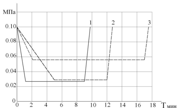
*Рис. 2. Режимы вакуумирования бетонных смесей в монолитных конструкциях.
