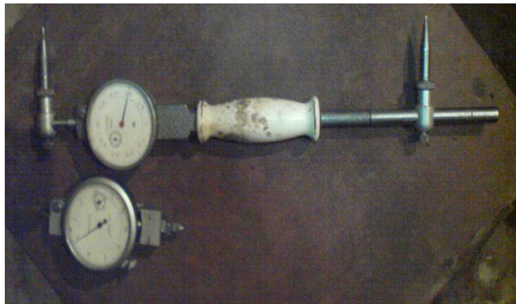
Рис. 2. Компаратори конструкції С. О. Слободянюка для вимірювання поздовжніх і поперечних деформацій
