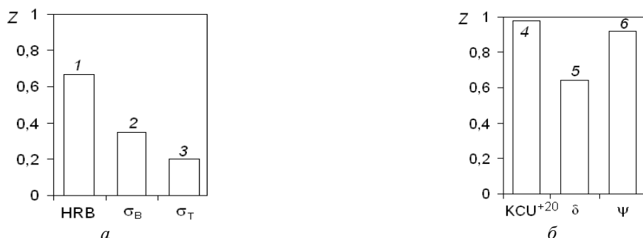
Рис. 1. Чувствительность прочностных свойств к перлитно-бейнитной группе (а) и вязких – к ферритной группе (б): 1 – регулярность перлита; 2 – однородность перлита и бейнита; 3 – однородность перлита; 4 – однородность феррита; 5 – регулярность феррита; 6 – регулярность феррита
