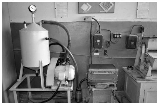
Рис. 2. Вакуумстанция для формирования золобетонных стеновых блоков
