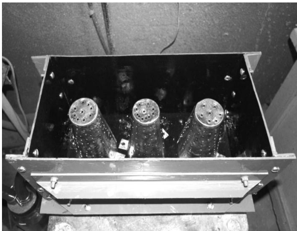
Рис. 1. Форма для формирования стеновых блоков методом виброввакуумирования
