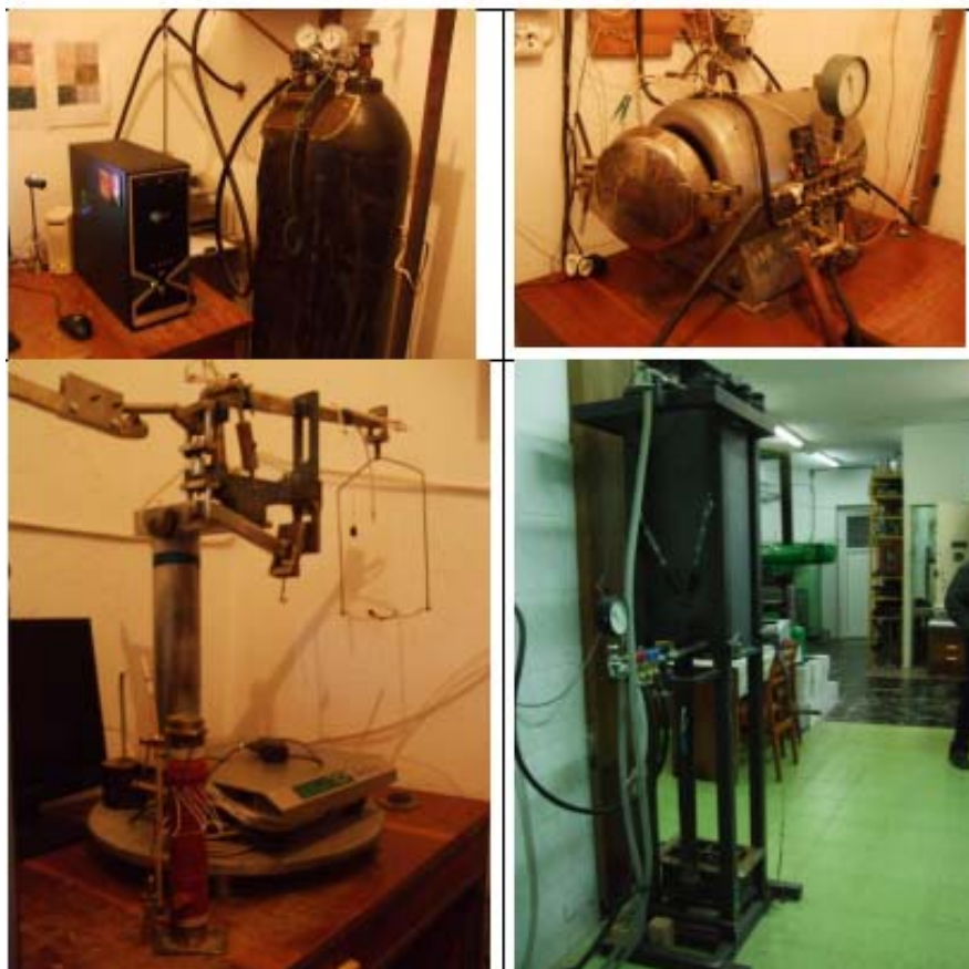
Рис. 7. Оборудование для исследования процесса кинетики отверждения жидкостекольных композиций углекислым газом
