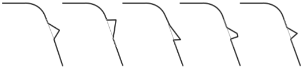
Рис. 1. Геометрия резбового элемента некоторых ввинчивающихся чашек
