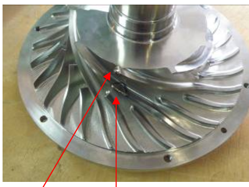
Рис. 5. Внешний вид моноколеса после восстановления
