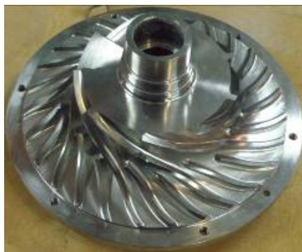
Рис. 1. Внешний вид моноколеса на стадии механической обработки
