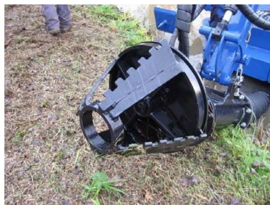
Рис. 7. Мобільні комплекси для розробки пелоїдів із фрезюю:
