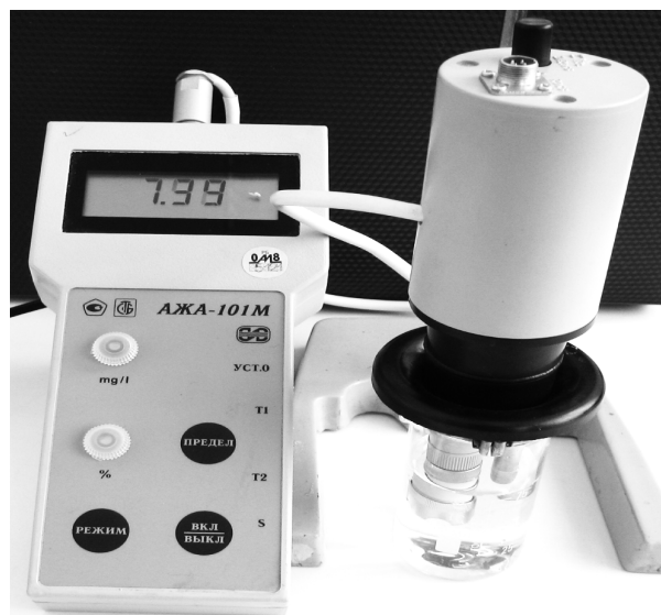
Рис. Амперметрична система кисневого електроду Кларка АЖА 101 М (Білорусь).
