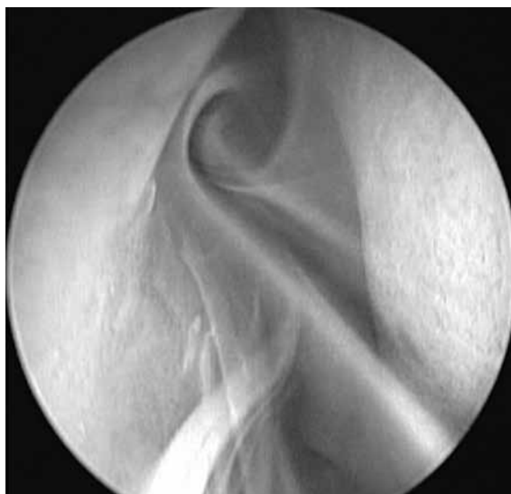
Рис. 2. Турбулентний рух повітря через носовий клапан.
