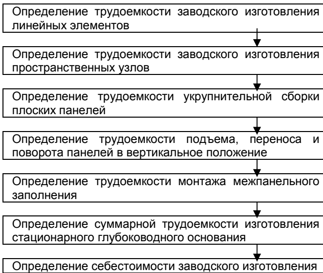
Рис. 4. Блок-схема выполнения расчета трудоемкости и себестоимости заводского изготовления стационарных глубоководных оснований по укрупненной методике
