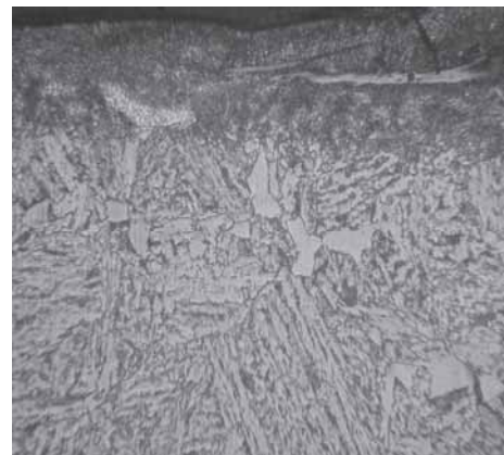
Рисунок 8 - Микроструктура покрытия Cu-Ti после лазерной обработки (ув. 500x)
