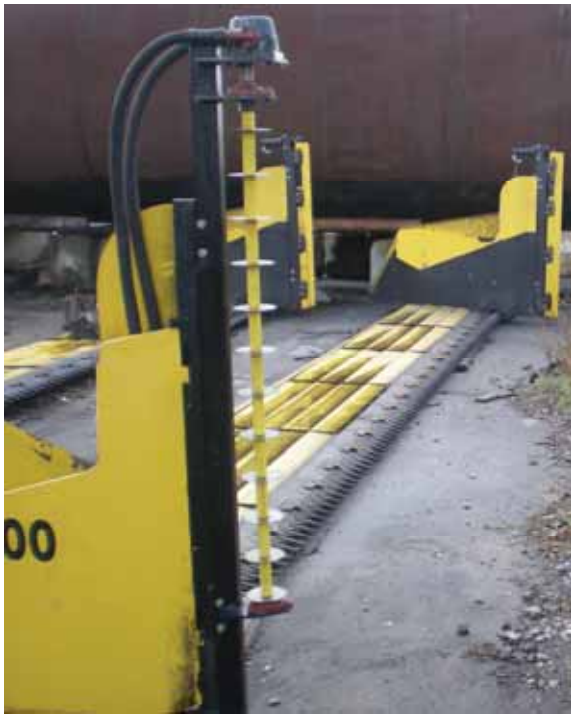
Рисунок 5 – Конструкція активного подільника жатки з горизонтально розташованими дисковими ножами.
