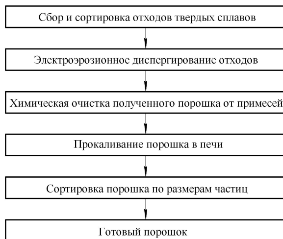
Рисунок 2 - Схема получения порошковых материалов методом ЭЭД из отходов твердых сплавов
