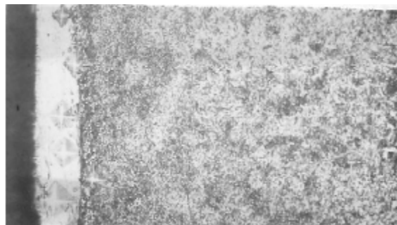
Рисунок 6. Микроструктура поверхностных слоев ЭЭЛ никелем после обкатки шариком D_{ш} = 10 мм, P_{cp} = 2060 МПа. \times 400 .
