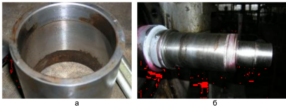
Рис. 1. Фреттинг-коррозия внутренней поверхности защитной втулки (а) и шейки ротора (б).
