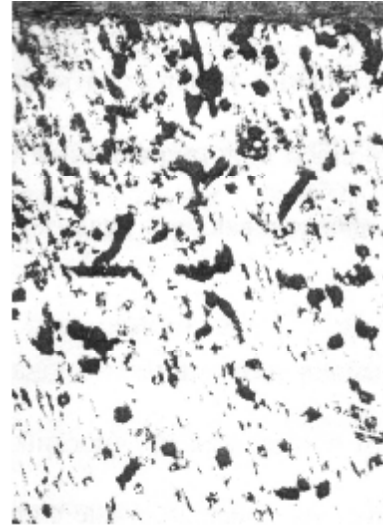
Рис. 3. Вид графитных включений, образовавшихся в микротрещинах (пластинчатый графит) и в микропорах (шаровидный и близкий к нему графит) при цементации закаленной стали 50C2. Не травлено. ( \times 400 )
